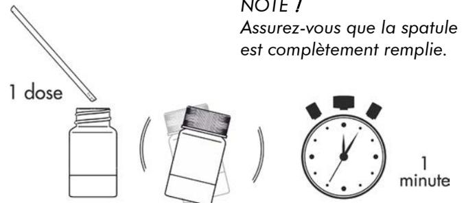
6. Après avoir patienté 1 minute, placez la fiole dans la chambre de mesure et appuyez sur la touche **MEAS** pour effectuer la mesure. Le résultat - **la concentration en sulfates** – sera affiché en **mg/l (ppm)**.
